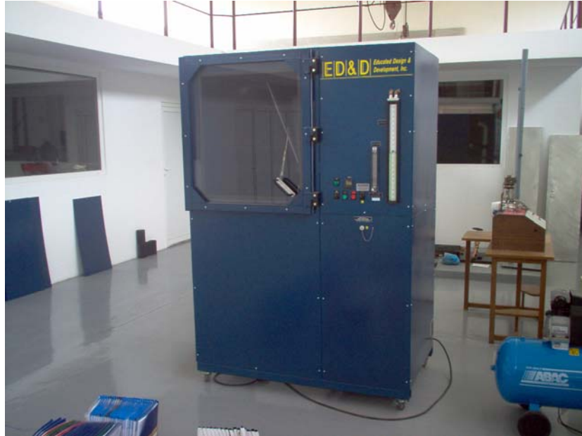
Figura 6. Aparat pentru verificarea protecției împotriva prafului pentru echipamente tehnice cu dimensiuni mici ( etuvă de praf)
