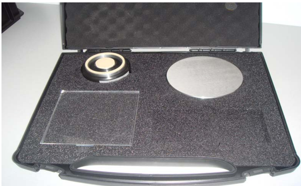
Foto 11 Aparat pentru măsurarea rezistivității de suprafață a materialelor
