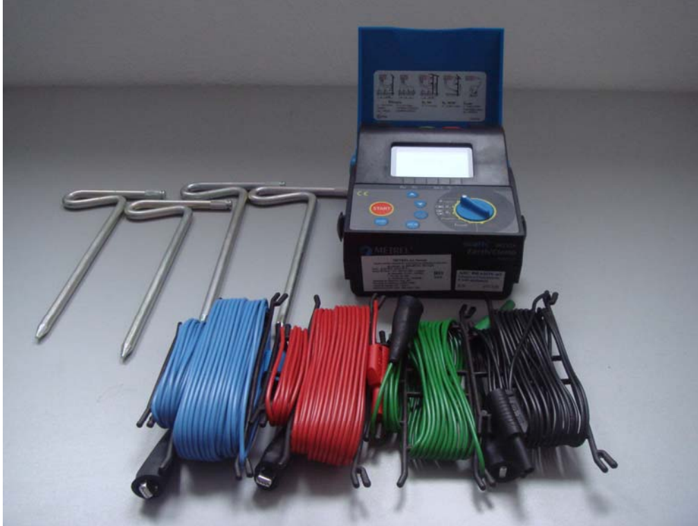
Foto 14 Aparat pentru măsurarea rezistenței de dispersie a prizelor de pământ
