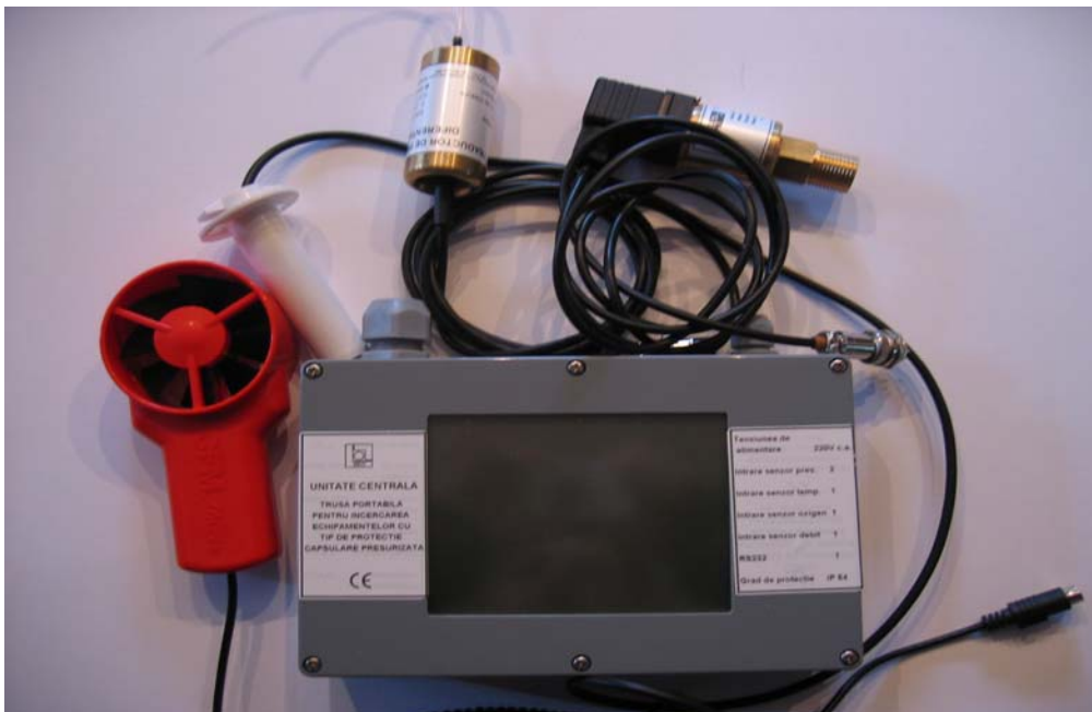
Fig 4- Aparat pentru controlul parametrilor de presurizare tip ACPP-2
