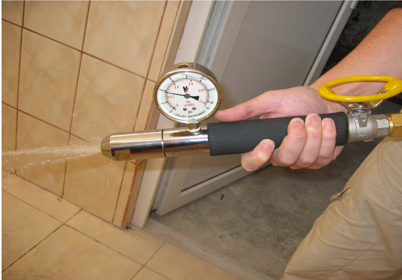
Fig. 9. Dispozitiv pentru determinarea protecției împotriva jeturilor puternice de apă (IP X6)
