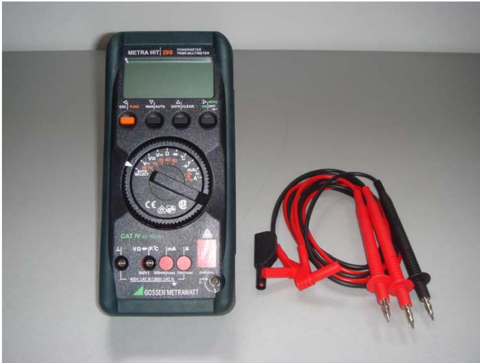
Foto 13 Aparat pentru masurarea capacitatii
