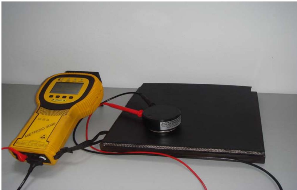
Foto 11 Aparat pentru măsurarea rezistivității de suprafață a materialelor
