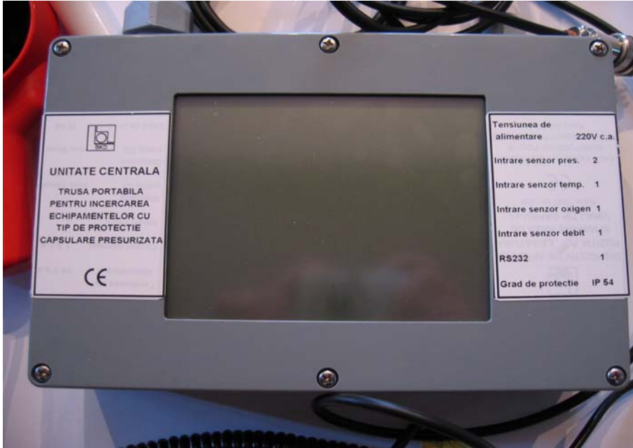
Fig 3-Unitatea centrala a stand-ului pentru controlul parametrilor de presurizare tip ACPP-2
