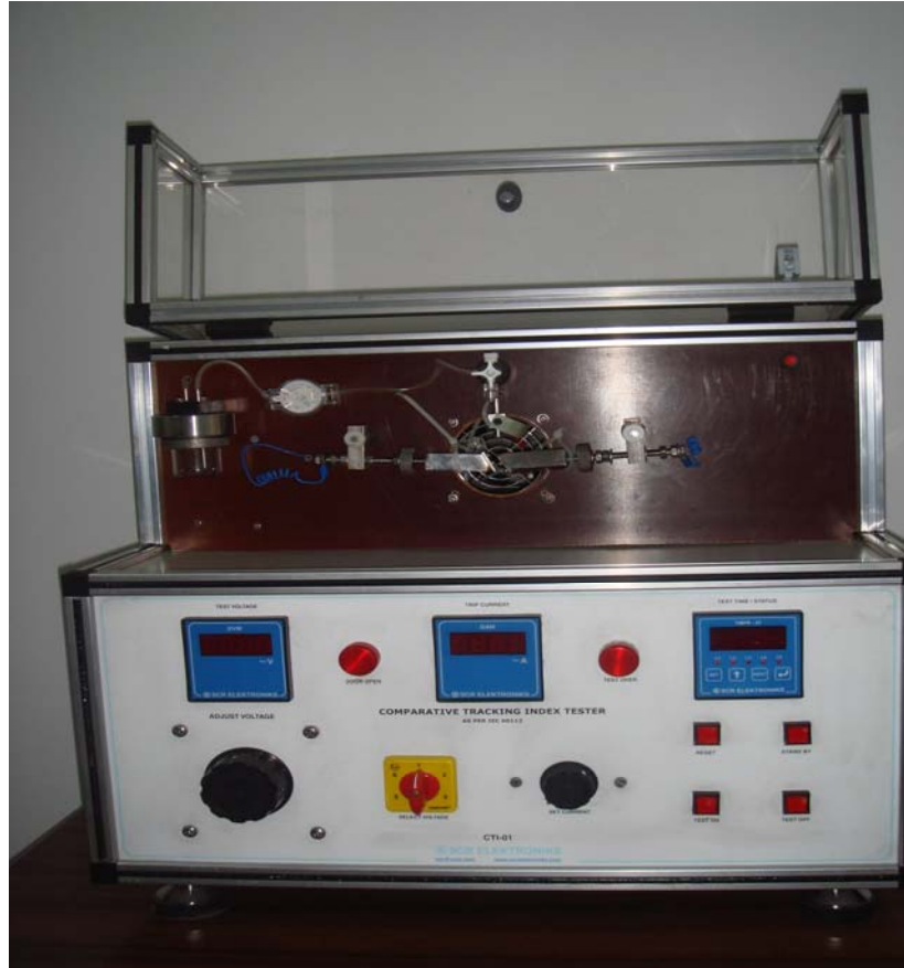
Foto 15- Aparat pentru determinarea indicelui de rezistență și de ținere la formarea de căi conductoare
