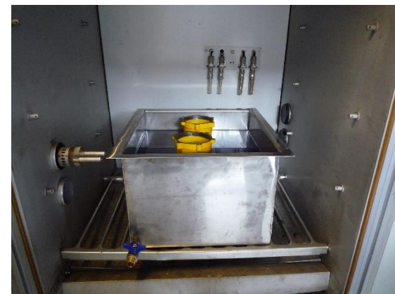
Fig. 1 Verificarea rezistenței la uleiuri și grăsimi
