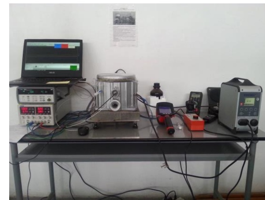
Fig. 1 Stand de încercare la aprindere a componentelor mici din echipamentele destinate utilizării în atmosfere explozive
