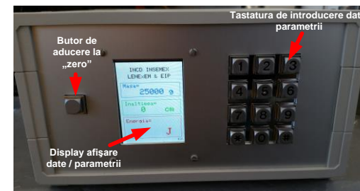
Fig. 1 Unitatea centrală a sistemului digital de determinare a înălțimii de cădere și de calcul al energiei de impact
