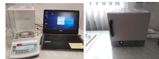
Fig. 2 a) Balanță analitică AXIS model ALN220G; b) Etuva de laborator SNOL model SNOL 24/200
