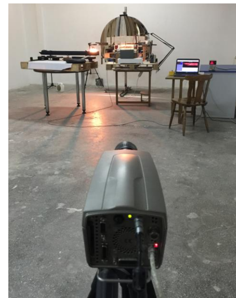
Fig. 1 Stand pentru cercetarea imagistică a exploziilor de gaze
