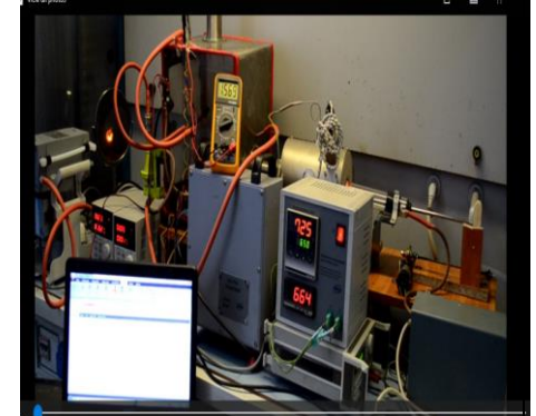
Stand experimental pentru determinarea efluenților de incendiu
