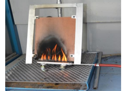
Stand experimental pentru determinarea eficienței ignifugării
