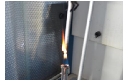
Stand experimental pentru determinarea vitezei de ardere pe verticală
