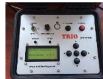
Fig. 1. Echipament multifuncțional performant pentru determinarea cu acuratețe ridicată a vitezei de detonație și a preciziei de întârziere
