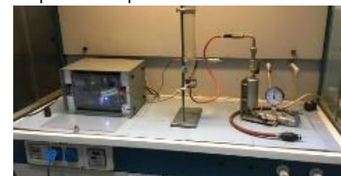
Sistemul universal pentru determinarea energiei minime de aprindere configurat pentru determinarea energiei minime de aprindere a prafulor combustibile
